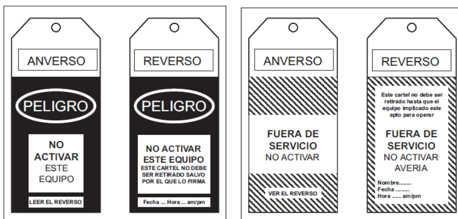
Carteles que pueden colocarse sobre los dispositivos de maniobra para que no sean accionados.
