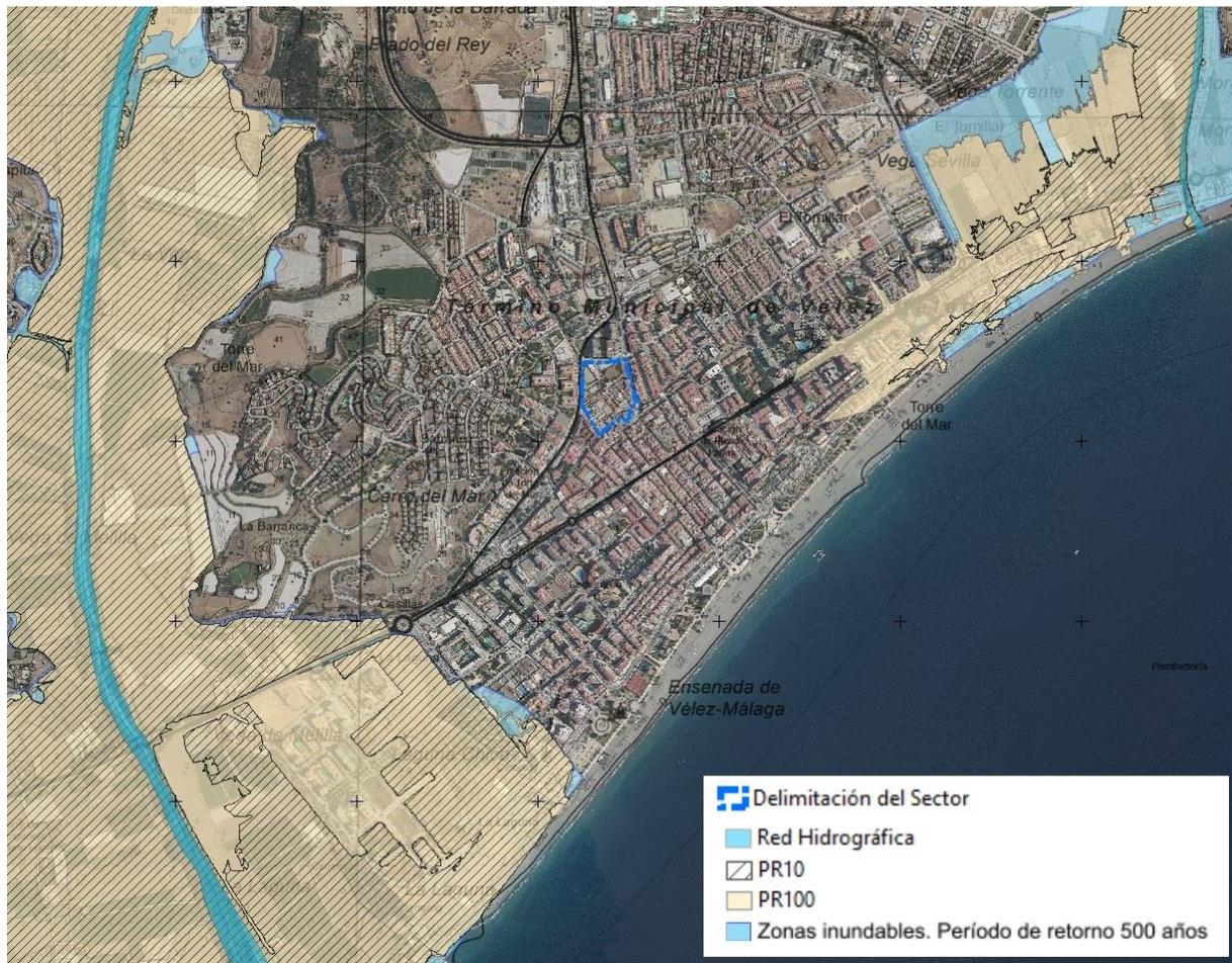
Ilustración 30. Láminas de inundabilidad fluvial del área.
