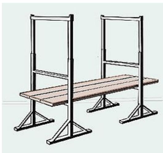
6.24.-Para su formación emplear caballetes de madera ensamblada o borriquetas metálicas, nunca construirlos con materiales sueltos u otros elementos (bidones, ladrillos, etc.)
