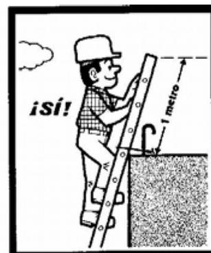
deben ser de una sola pieza y los peldaños deben estar ensamblados y no solamente clavados.
